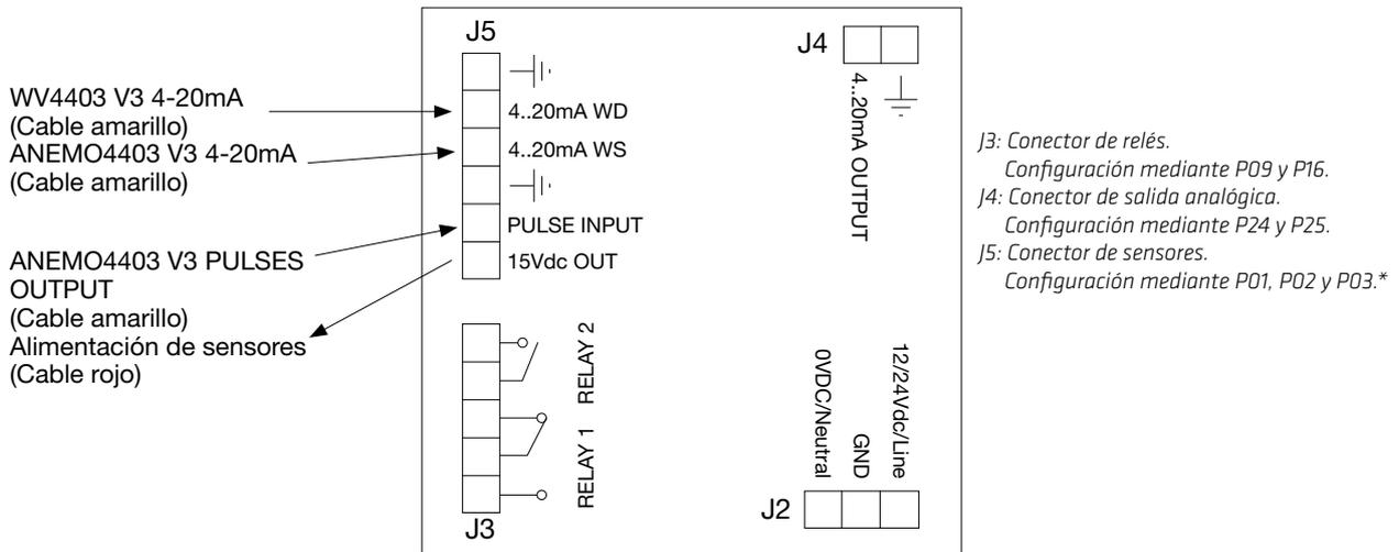
\*Nota: Si la configuración escogida por el usuario requiere de dos sensores cableados al equipo WM44-EVO11 debe utilizarse el accesorio T-Box (ref. 0106030405).
