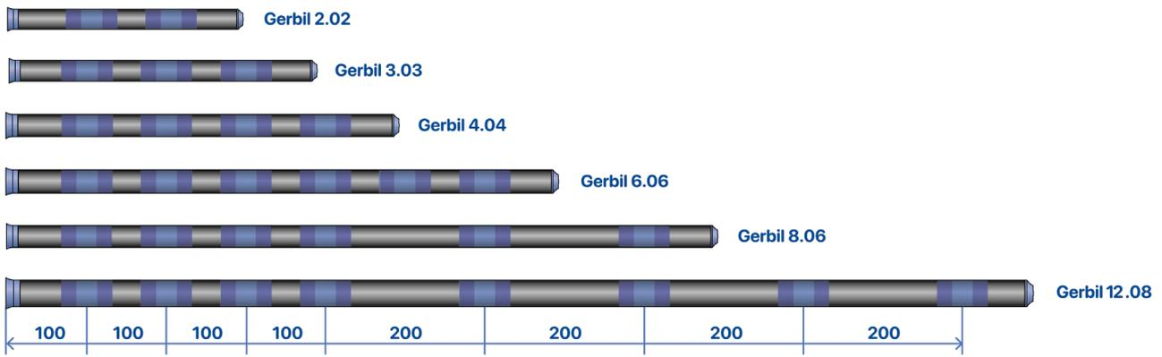
Opcionalmente existe la posibilidad de realizar sondas de diferente longitud y distribución de sensores.
